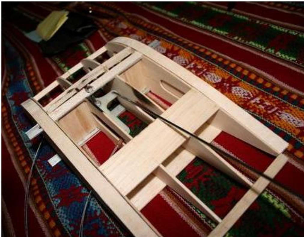
Una forma diferente de armar el sistema: El centro del ala es independiente del fuselaje
