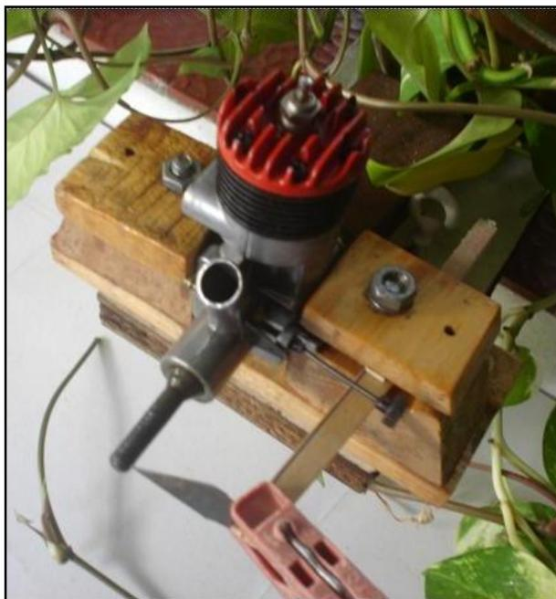
Aún una pequeñísima desviación, imperceptible a primera vista y solo detectable a través del método que acabamos de describir, desencadenará vibraciones que provocarán serios daños a nuestro aeromodelo.
