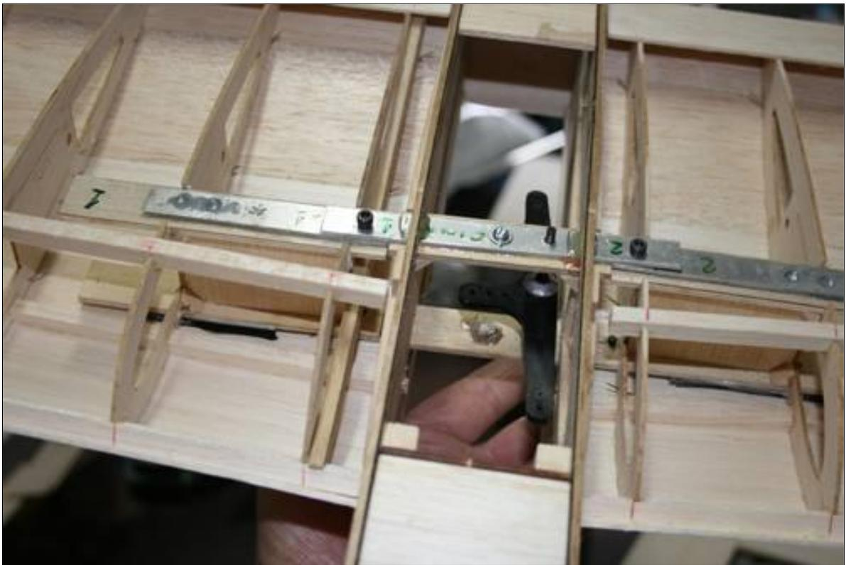
Como se puede apreciar cada uno de los flejes son montados sobre terciada de 1/8", los del fuselaje también actúan como soporte del balancín. Las terciadas que van en las semi-alas llevan empotradas las tuercas donde los tornillos aseguran el sistema.
