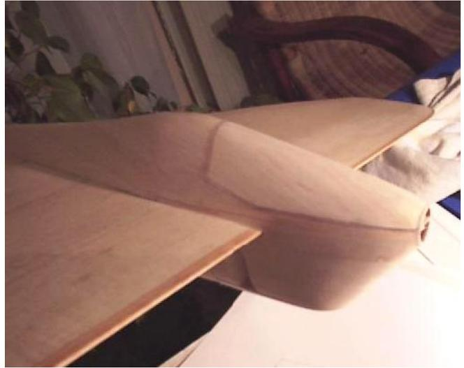
14) La cabina está casi lista, volvamos al fuselaje y cortemos los pisos que hicimos exactamente como necesitamos, gastamos un poco de tiempo para darle la forma exacta, pero la unión entre la cabina y el fuselaje debe ser perfecta.
