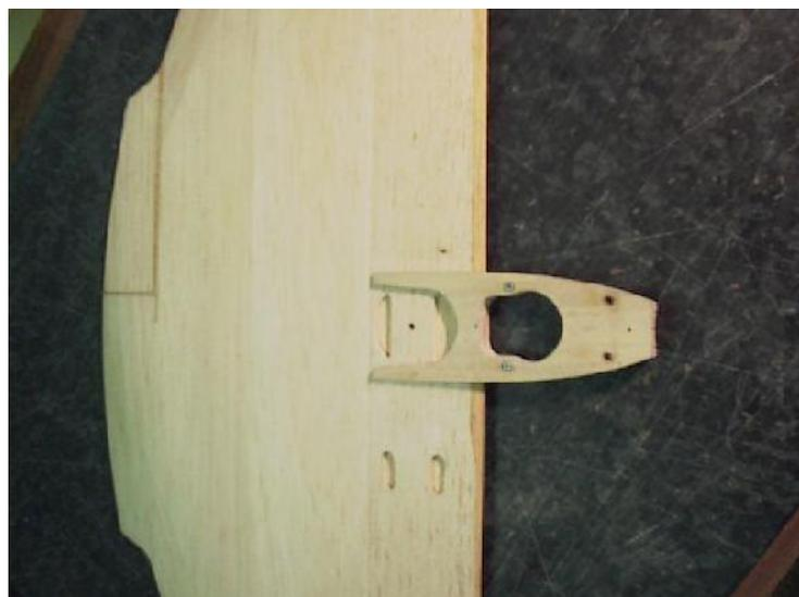
Para cada motor que utilizamos (las dos generaciones de Vorobiev y la actual generación del Yougov) preparamos algunas plantillas para dibujar la ubicación de los agujeros del motor y todos los cortes que debemos realizar para colocarlo fácilmente en su lugar: El agujero para el cilindro (diámetro del cilindro más 1 mm), espacio para la parte frontal del motor (queda una parte de madera debajo del rulemán frontal), y ubicación del back-plate.
