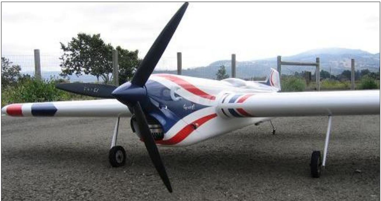
Como planta motriz utiliza un PA .75 con pipa Eather #8 y hélice Eather de 13" x 3.9" flat-back, tripala de carbono. Realmente, un modelo con pasta de campeón.
