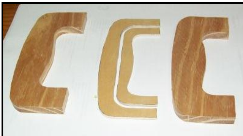
Las cachas y terciado central listos para ensamblar
