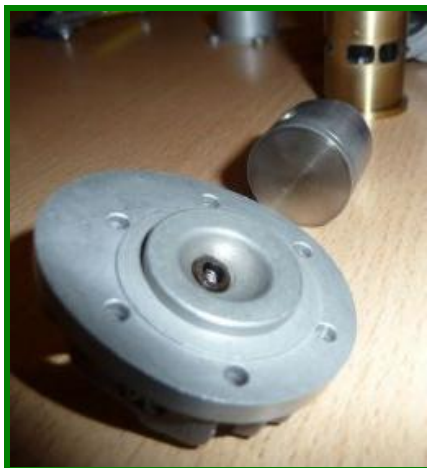
Vista de la Tapa del cilindro (ver bujía inclinada) y sistema de Aguja Remota
