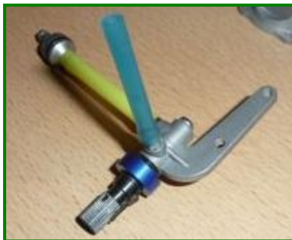
Vista de la Tapa del cilindro (ver bujía inclinada) y sistema de Aguja Remota
