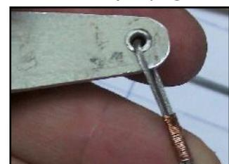
Para facilitar la operación de soldadura, coloqué una gota de "decapante" utilizado en plomería con la ayuda de un soldador de 100W y estaño como el utilizado en electrónica (60% estaño y 40% plomo) ...le puedo asegurar que tardó más en calentarse en soldador que los 5Seg que tarde en hacer la soldadura.
