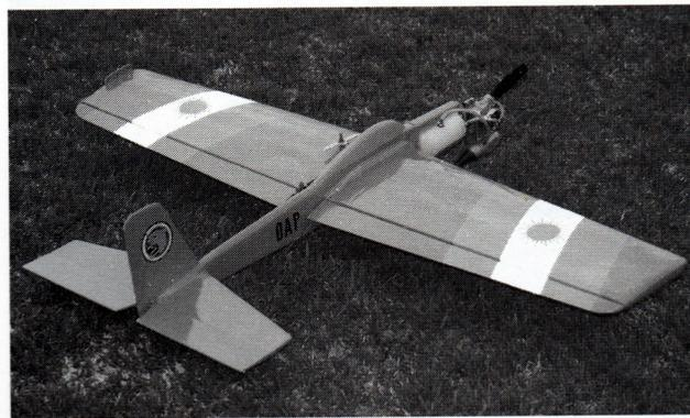
Este es un entrenador de U/C diseñado por Omar Paggi, con motor O.S. 25, fuselaje tipo silueta, y ala desmontable. El plano será publicado próximamente en esta revista.
