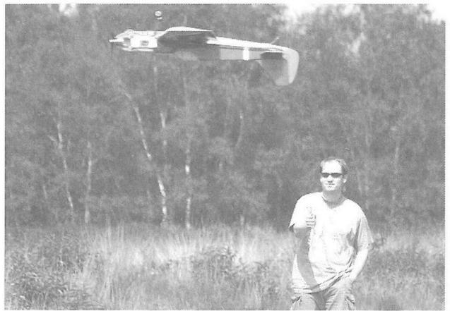
Este es el “Bf-109” cuyo plano aparece en la página 32. Tiene una envergadura de 33 pulgadas (838 mm) y es para motores glow en la gama .15 a .20, pero al de la imagen se le instaló un motor eléctrico equivalente.
