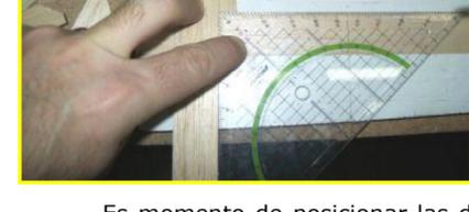
Ahora posicione -y sujete fuertemente- como se indica en el plano el fleje principal del instrumento a la parte que contiene la lámina y una de las mordazas. Cuando esté seguro de la alineación coloque unas gotas de cianocrilato inmortalice la unión de estas tres partes.
