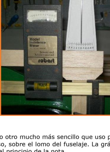
Como le comenté antes, de una plancha de balsa pueden salir 3 medidores completos, si los construyó deberá de verificar, si los construyó con les coménté, o sea, realizar una medición simultánea (medir en el mismo lugar y en las mismas condiciones) y comprobar que todos ofrecen idéntica lectura.
