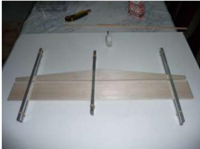
**Ref 16:** *Puntera y BF*, aquí pueden emplearse tanto varillas de pino como láminas de madera dura (de las comúnmente utilizadas en el acabado de muebles) colocadas en varias capas. El objetivo es lograr un cierre del ala, reforzando además el BF para evitar deformaciones de la balsa.
