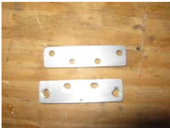
**Ref 3:** *tren de aterrizaje*, en este caso confeccionado con plancha de acero de 1,25 mm de espesor (comúnmente utilizada para la elaboración de cierras sin-fin de carpintería). Puede reemplazarse por aluminio de mayor espesor o alambre, pero la pierna en acero fino tiene una buena relación resistencia / flexibilidad, resultando también muy cómoda la fijación.
